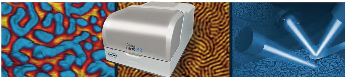
ナノスケール赤外分光法は、AFMと高性能IRレーザーとの組み合わせにより光の回折限界を超える超微小領域から対象の赤外吸収特性を得る新しい分析技術です。ナノスケールのケミカルイメージング及びスペクトル測定は、試料の化学組成や分散状態、そしてそのナノ光学特性を容易に可視化します。
