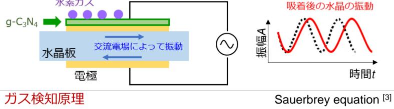
電極上に製膜した膜にガス分子が吸着
