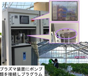
プラズマ装置にポンプ類を接続しプログラム自動運転でPALを調製して, 土壌へ灌水する
